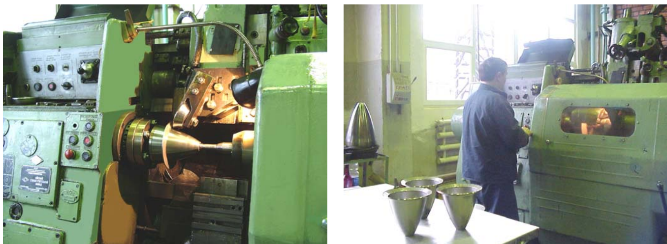
Рисунок 3. Фрагмент процесса РВ сверхзвуковой части сопла ЖРДМТ 11Д458 на гидрокопировальном полуавтомате мод. 1722
