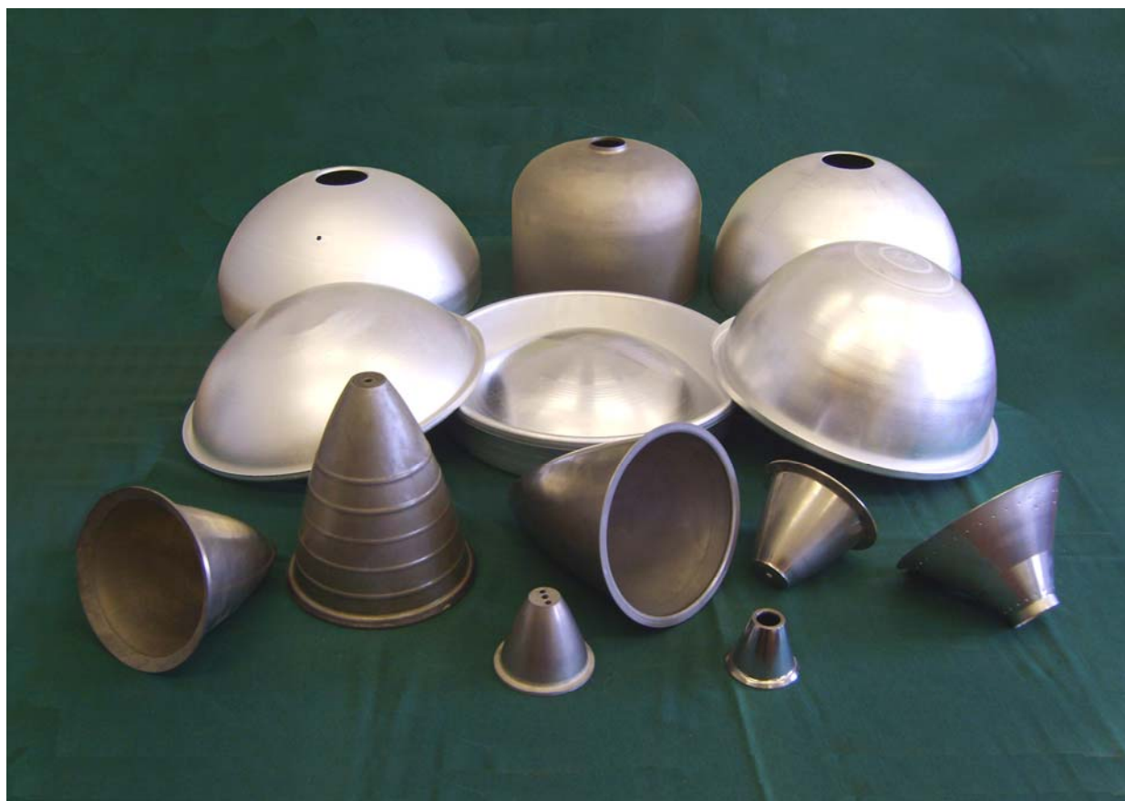
Рисунок 1. Номенклатура деталей, изготавливаемых РВ (сверхзвуковые части сопел жидкостных ракетных двигателей малой тяги (ЖРДМТ), теплозащитный кожух ЖРДМТ 11Д458М, полусферы и диафрагмы двухкомпонентного и однокомпонентного баков)
