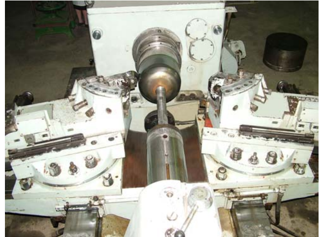
Рисунок 9. Фрагмент РВ титановой полусферы на токарно-давилном станке КЖ9901
