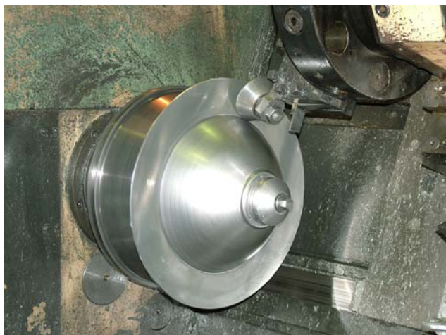
Рисунок 6. Фрагмент РВ отражателя на токарном станке РТ724 Ф3 с ЧПУ
