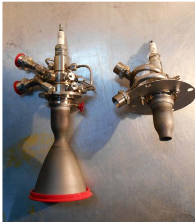
Рис.3 – Полноразмерный (слева) и стендовый (справа) варианты камеры КВ-16. Стендовый вариант (геометрическая степень расширения сопла 1,47) выполнен для экспериментальной отработки камеры в земных условиях
