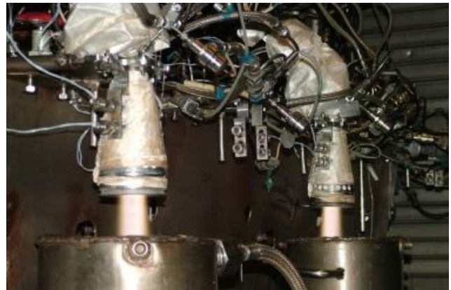
Рис.8.-Схема установки двигателя на стенде.
