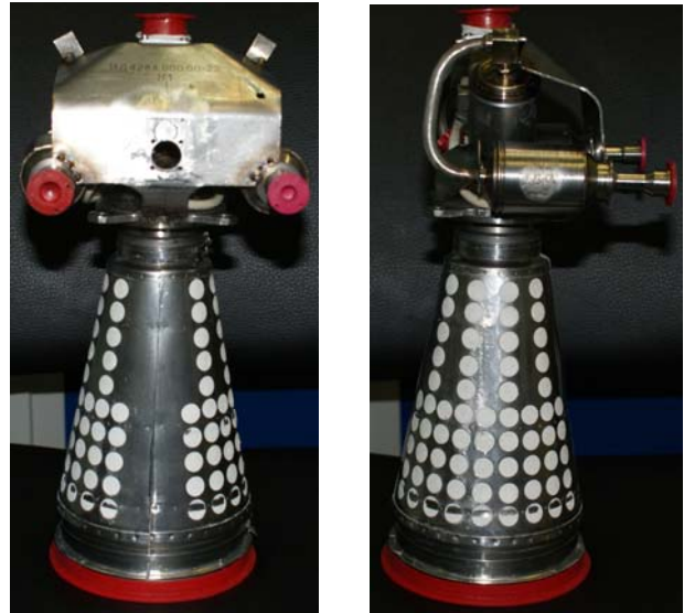
Рис. 7.- Схема установки сифонного СР в двигателе 11Д428А.000.00-22
