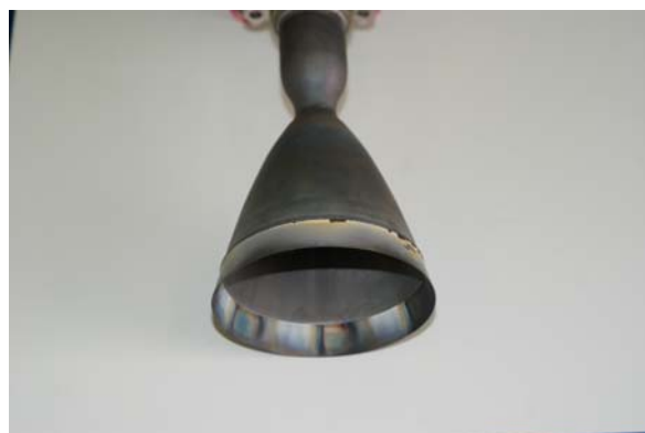
Рисунок 3. – Сопло с титановым насадком после огневых испытаний.
