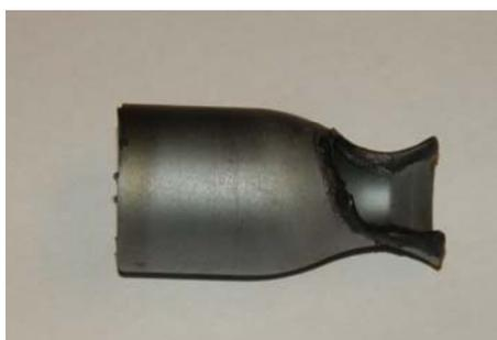
Рис. 4. Корпус камеры после прогара
