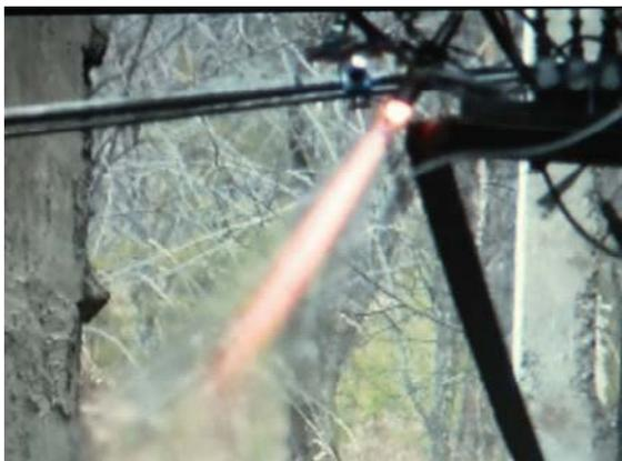
Рис 3. Огневой пуск №3 камеры.
