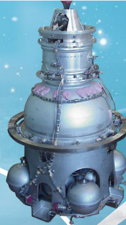
Двигательная установка КДУ 11Д414НС для спутника связи
